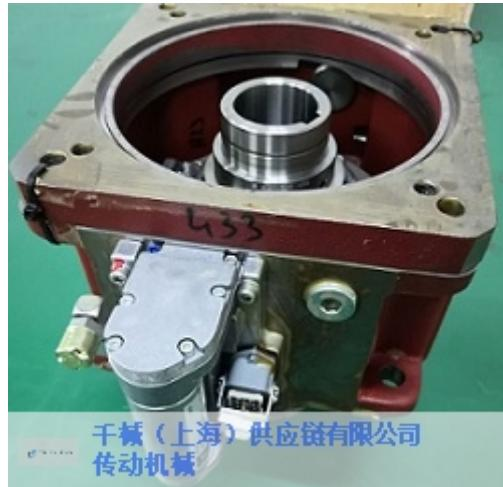
机床的设计需要通用性，可以用来加工各种材料。所以既需要高速切削来加工柔性材料，也需要高的切削力来加工硬质材料，此时ZF双速齿轮箱可以很好的满足这个要求，因为它既可以获得很高的电机转速( $i=1:1$ 的时候)，也可以利用减速比（例如速比 $i=40$ 来增加扭矩降低主轴转速。
